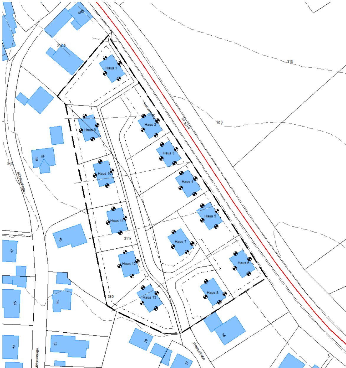
Übersichtslageplan im Schallschutzprogramm: Geplante Gebäude (Haus 1 bis Haus 13) und generierte Immissionspunkte je Gebäude sowie Verkehrslärmquelle ST 2240
