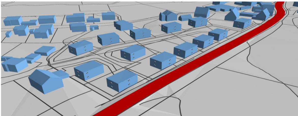
3D-Darstellung im Schallschutzprogramm: Geplante Gebäude (Haus 1 bis Haus 13) und generierte Immissionspunkte je Gebäude / Blickrichtung Westen
